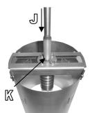
10) Fädeln Sie die Rotorkugel wieder über die Welle. Bedenken Sie, dass wenn Sie zum Dämpfungsschlauch kommen der Rotor wieder mit einer leichten Hin/Her Bewegung gefühlvoll über den Dämpfungsschlauch eingefädelt werden muss. Fixieren Sie nun den Rotor mit der Edelstahlhutmutter am oberen Ende (L).
