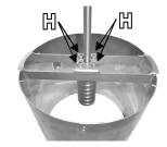
9) Stülpen Sie nun den beigelegten Dämpfungsschlauch oben über die Welle.
